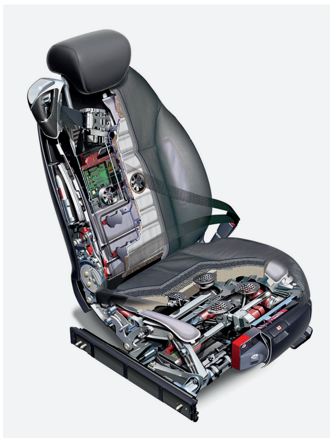
Рис. 17. Автомобильное кресло в разрезе
