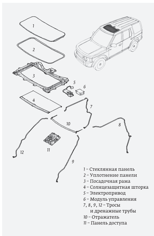
Рис. 10. Устройство сдвижного люка автомобиля
