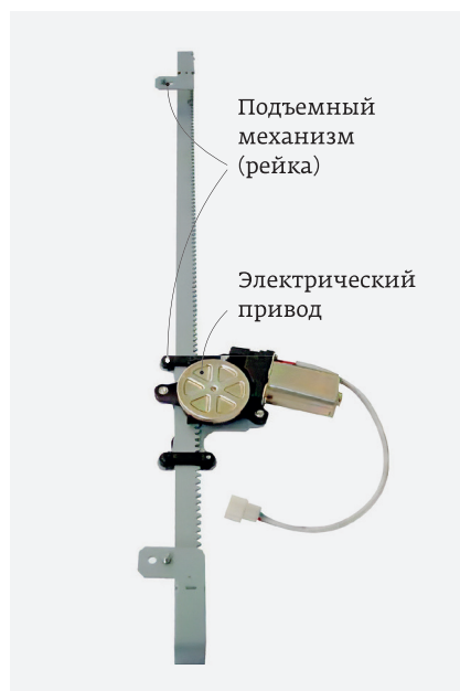
Рис. 14. Реечный механизм стеклоподъемника
