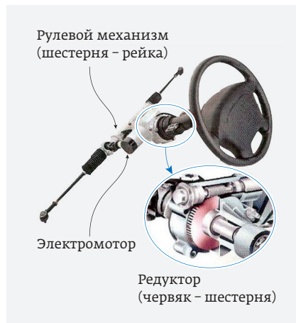
Рис. 3. Устройство ЭУР
