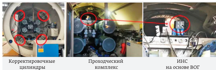
Рис. 6. Модуль на основе ВОГ в машине для микротоннелирования [6]
