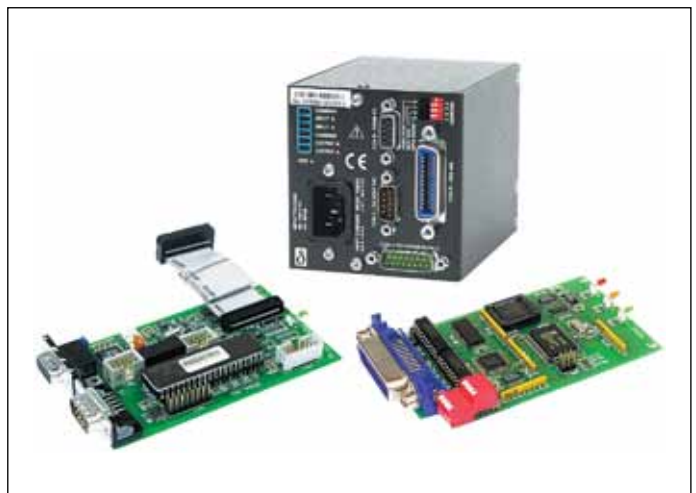
Рис. 14. Контроллеры управления по IEEE488 и RS-232: встроенный интерфейс (встраиваемая плата) и внешний модуль
